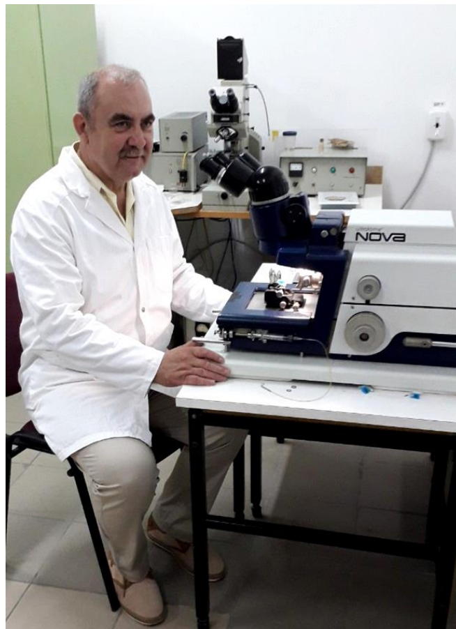
Виготовлення ультратонких зрізів для електронномікроскопічних досліджень (Львівський національний університет ветеринарної медицини та біотехнологій імені С. З. Гжицького, 2019 рік)
