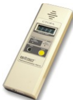
Рис. 2.6. Радіометр-дозиметр гамма-, бета-випромінень РКС-01 „Стора”
